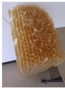
写真. 瓦田浄水場管理棟（左）と 生物ハニカムチューブ（右）
